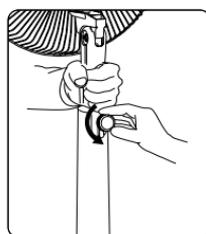
右手にてスライドパイプ固定ネジを反時計廻りの方向にゆっくり回す。
