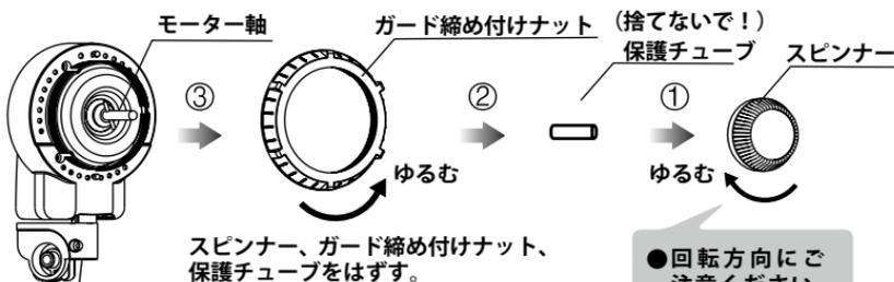
※保護チューブは扇風機を保管する時、モーター軸のサビ防止となりますので捨てないでください。
