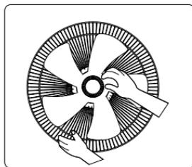
● 使用中に羽根が緩まないように、「しまる」方向にしっかりと締め付けてください。
