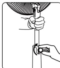
左手で支持した状態で右手にてスライドパイプ固定ネジを時計廻りの方向に回し、確実に固定してから手を離してください。
