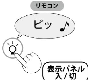
表示パネルスイッチを押すとパネルが消灯します。再度押すと表示します。
